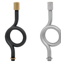
Evita averías y desajustes en los manómetros. Amortigua los cambios bruscos de presión o golpes de ariete que provocan desajustes en los manómetros. Aísla al manómetro de temperaturas extremas, creando un espacio de aislamiento térmico. En el supuesto de que trabaje con vapor, asegura que el manómetro actúe por acción del agua de condensación y no por el vapor.
