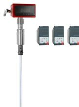
Dieses Gerät gewährleistet in Verbindung mit einem motorisierten Ventil eine kontinuierliche Regelung und Füllstandsanzeige mit Hoch und Tiefalarm in Dampf- und Heißwasserkesseln, Autoklaven usw. Gemäß TDR-602, TDR-604 (24/72 Stunden) und EN-12953 Teil 6 (24 Stunden).
