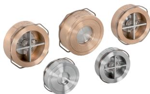
Soupape de retenue à disque avec anneau de centrage pour mise en place entre brides selon les normes DIN, UNE, ANSI, BS, etc. DN-15 à 100 Longueur de montage réduite selon EN-558, série de base 49.
