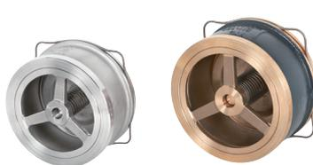
Soupape de retenue à disque avec anneau de centrage pour mise en place entre brides selon les normes DIN, UNE, ANSI, BS, etc. DN-125 à 300. Longueur de montage réduite selon EN-558, série de base 49 et 51.
